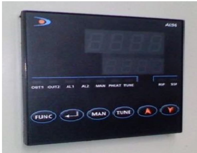
Figure 2.12 : régulateur industriel AK 96
