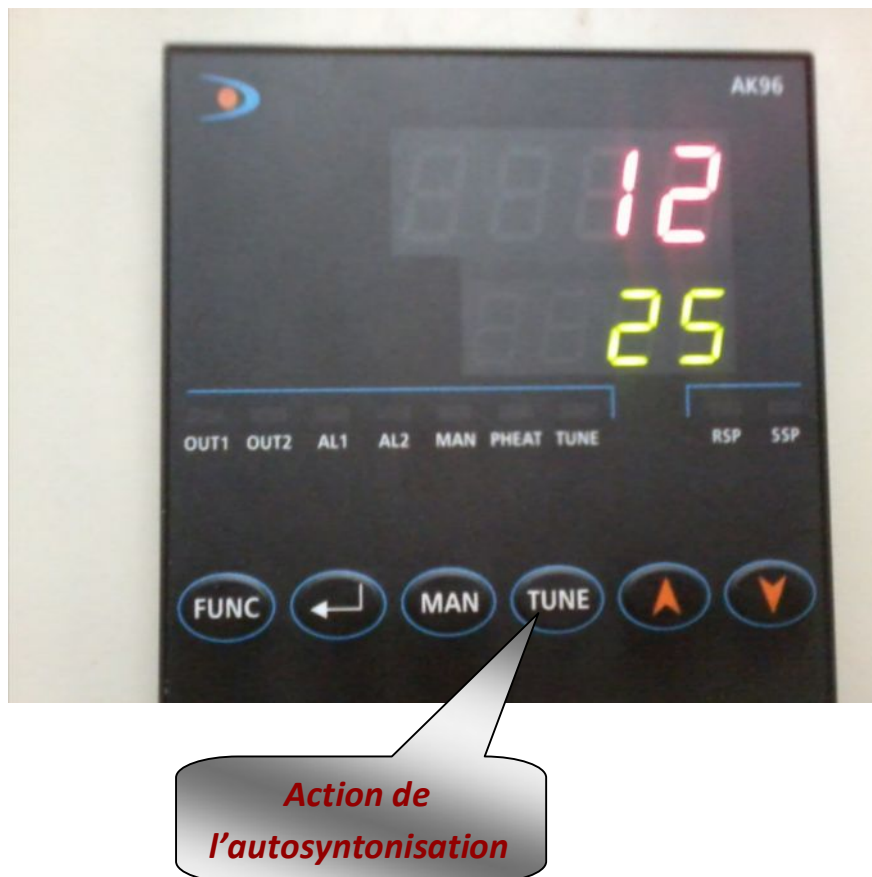
Figure 2.29: l’autosyntonsisation du régulateur AK96.
