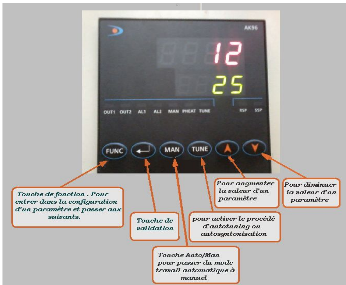
Figure 2.13 : signification de chaque bouton du régulateur AK96
